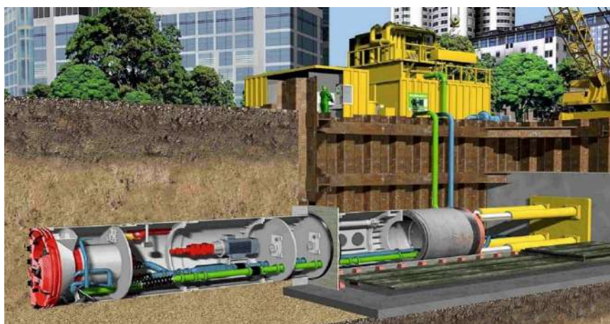
Рис.4. Технология микротоннелирования с железобетонными трубами
