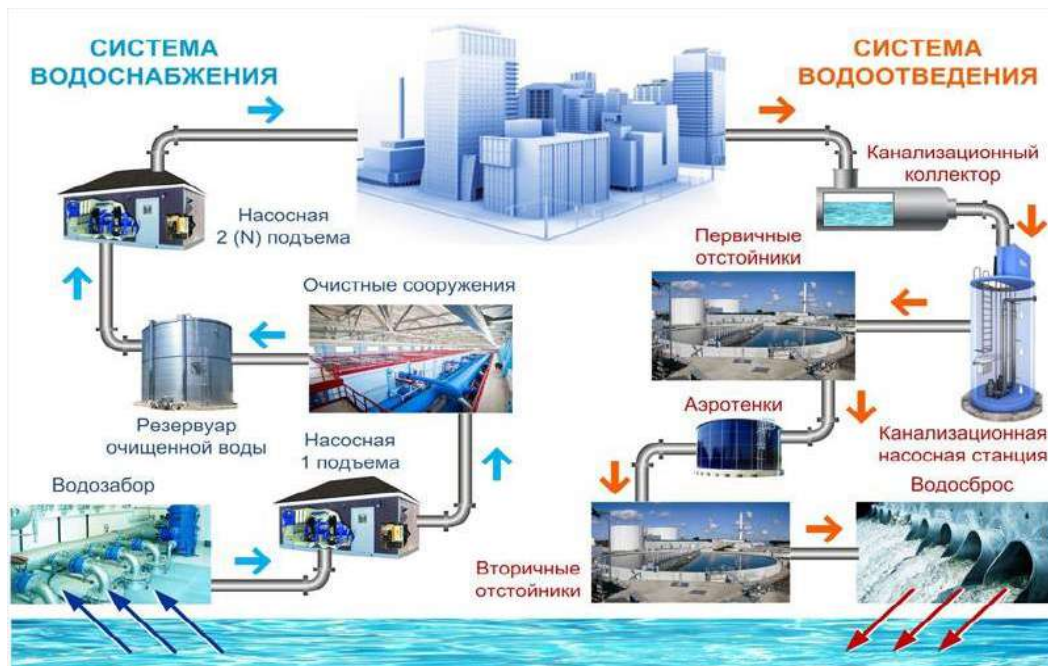
Рис. 5. Системы замкнутого водоснабжения
