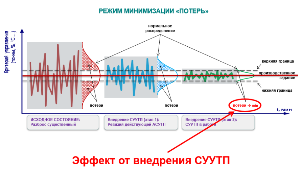
Рис. 4. Изменение критериев управления при работе в режиме минимизации потерь после внедрения СУУТП
