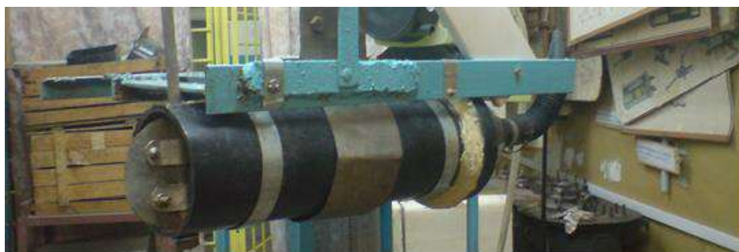
Рис. 5. Изменение подачи воздуха регулировалось поворотной заслонкой
