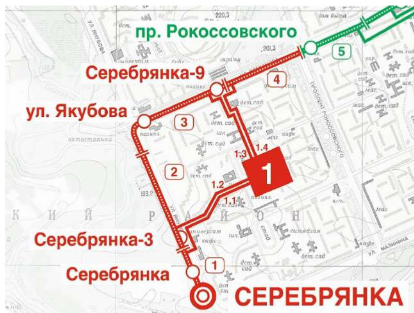
Рис. 2. Принципиальная схема секционирования части трамвайной линии в микрорайоне «Серебрянка» в г. Минске
