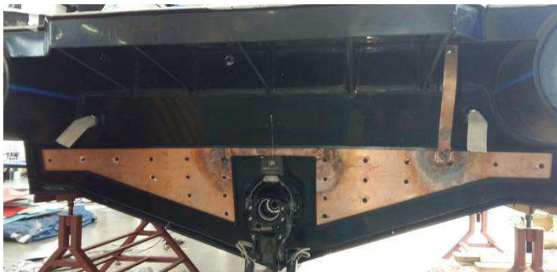
Рис. 5. Пример размещения и крепления заземлителя из листовой меди на транце пластикового катера
