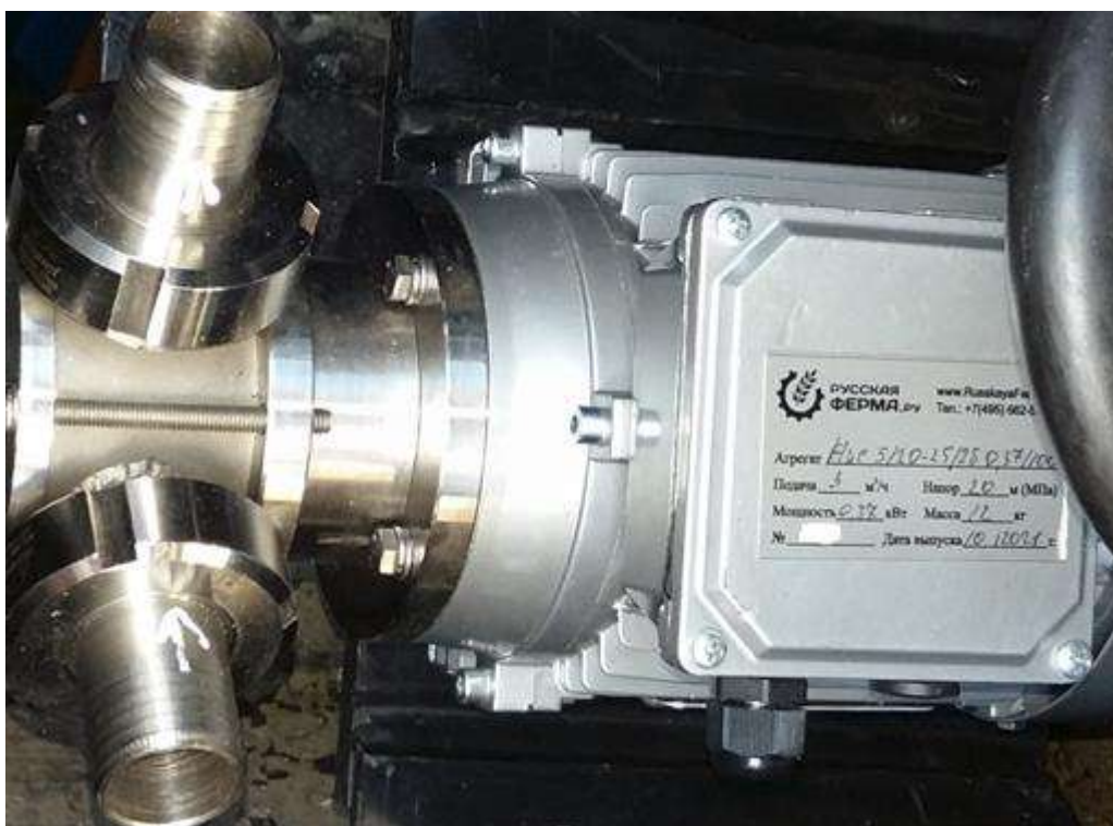
Рис. 3. Насос импеллерный НИС-3/20-0,37/1000 с трехфазным АД, 370 Вт, ~380/220 В, 50 Гц
