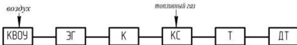
Рис. 1. Функциональная схема расчета газотурбинного двигателя КВОУ – комплексно воздухоочистительное устройство, ЭГ – электрогенератор, КС – камера сгорания, Т – турбина, КУ – котел-утилизатор, ДТ – дымовая труба
