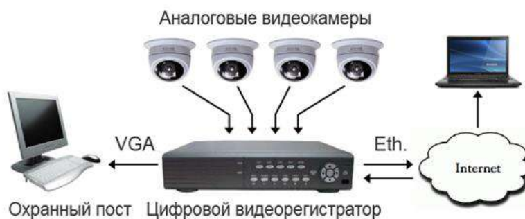
Рис. 2. Схема аналогового видеонаблюдения
