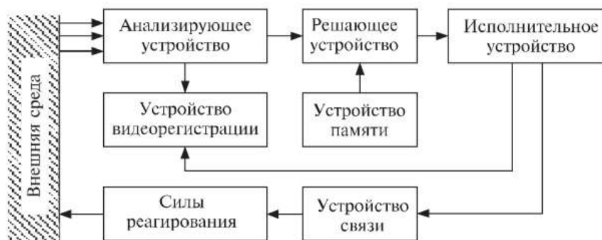
Рис. 1. Построение системы видеонаблюдения
