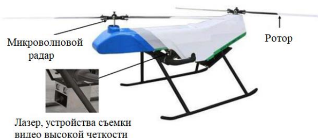
Рис. 1. Беспилотник, используемый в системе пожаротушения LY100
