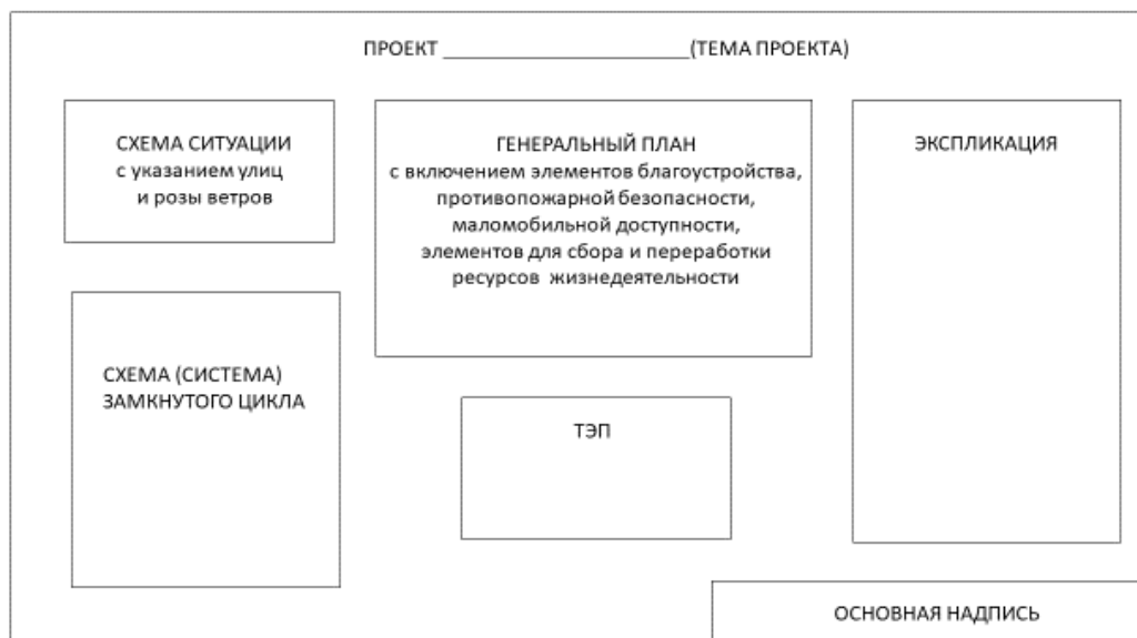
Рис.11. Рекомендуемая компоновка графического листа проекта ОКС с системой замкнутого цикла циркулярной экономики
