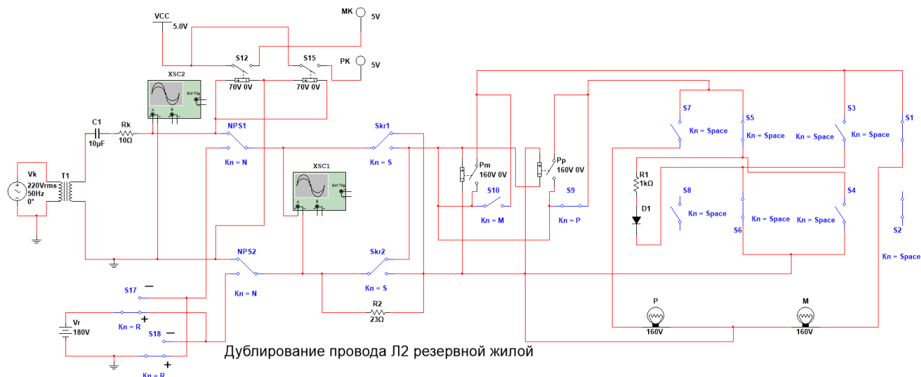
Рис. 6. Имитационная модель двухпроводной схемы управления стрелкой в режиме скрещивания линейных проводов Л1 и Л2
