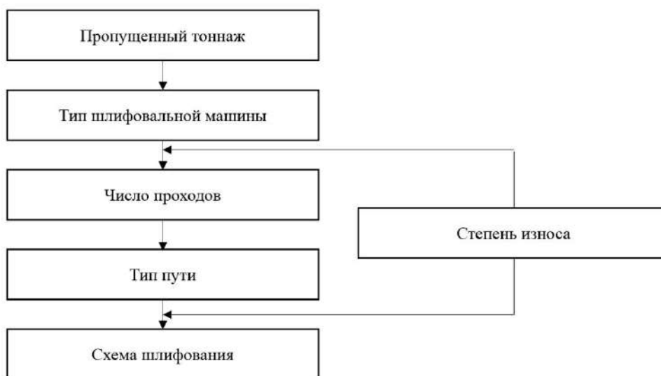
Рис. 7. Схема назначения удаления поверхностных дефектов
