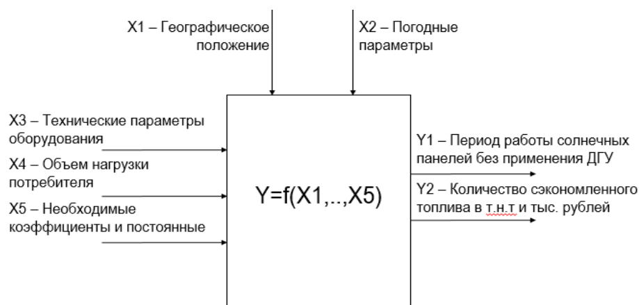
Рис. 2. Блок схема математической программы для оценки работы электростанции «Дизель + Солнце»
