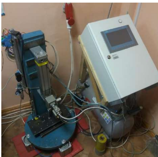
Рис. 1. Стенд для проведения испытаний на многократный удар
