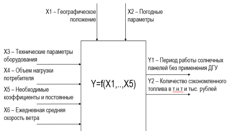
Рис. 3. Блок схема математической программы для оценки работы электростанции «Ветер + Солнце»
