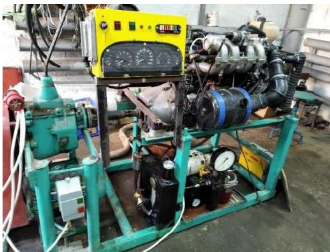
Рис. 1. Стенд с возможностью обеспечения режимов нагружения приборными методами и электродвигателем в его конструкции
