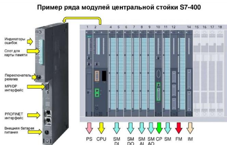
Рис. 5. Схема расположения модулей в промышленном программируемом логическом контроллере SIMATIC S7-400
