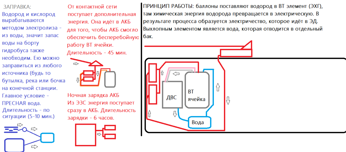
Рис. 6. Схема работы метода «Штанги + ВТ ячейка»
