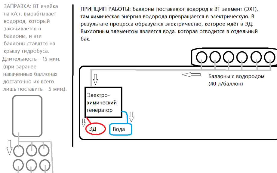
Рис. 4. Схема работы метода «Баллоны»
