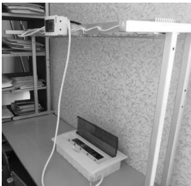
Рис. 4. Установка с регулятором световых потоков светодиодов
