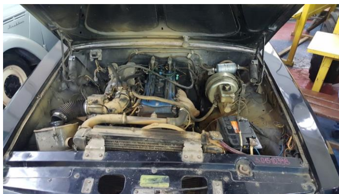
Рисунок 3.14 – Объект испытания двигатель ЗМЗ-406.10.
