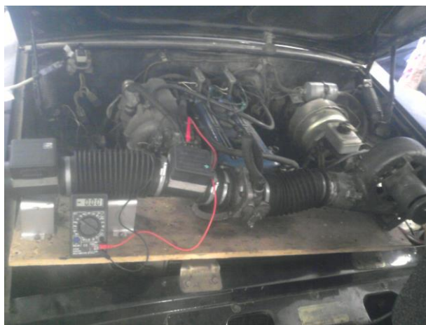
Рисунок 3.3 – Установка для диагностирования ДМРВ в производственных условиях станции технического обслуживания «Интервал»
