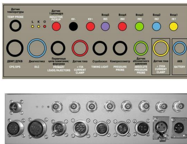
Рисунок 3.12 – Мотор-тестер МТ-10 вид сверху и спереди (со стороны разъемов)
