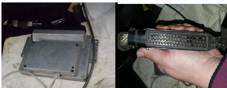
Рисунок 3.16 – Подключение отключателя электромагнитных форсунок в диагностический разъем
