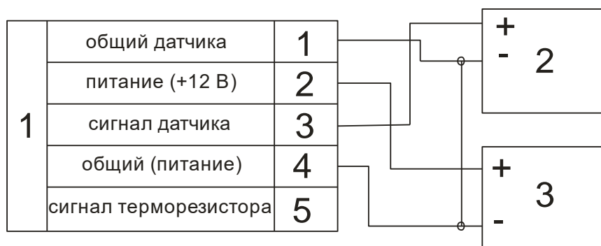
Рисунок 1.13 – Метод контроля ДМРВ при помощи регулируемого блока питания и контрольного вольтметра: 1 – контролируемый ДМРВ, 2 – измерительный вольтметр, 3 – регулируемый блок питания
